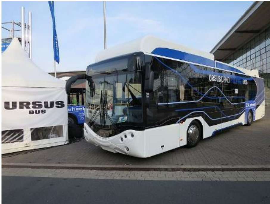
Rys. 2.4 Autobus elektryczny z wodorowymi ogniwami paliwowymi
