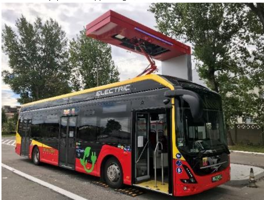
Rys. 2.3 Autobus elektryczny akumulatorowy na stacji szybkiego ładowania w Świdnicy
