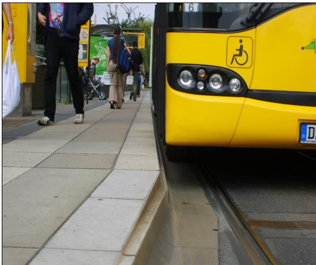
Rys. 30 Zalecane ukształtowanie krawędzi peronowej (Drezno – Niemcy) 58
