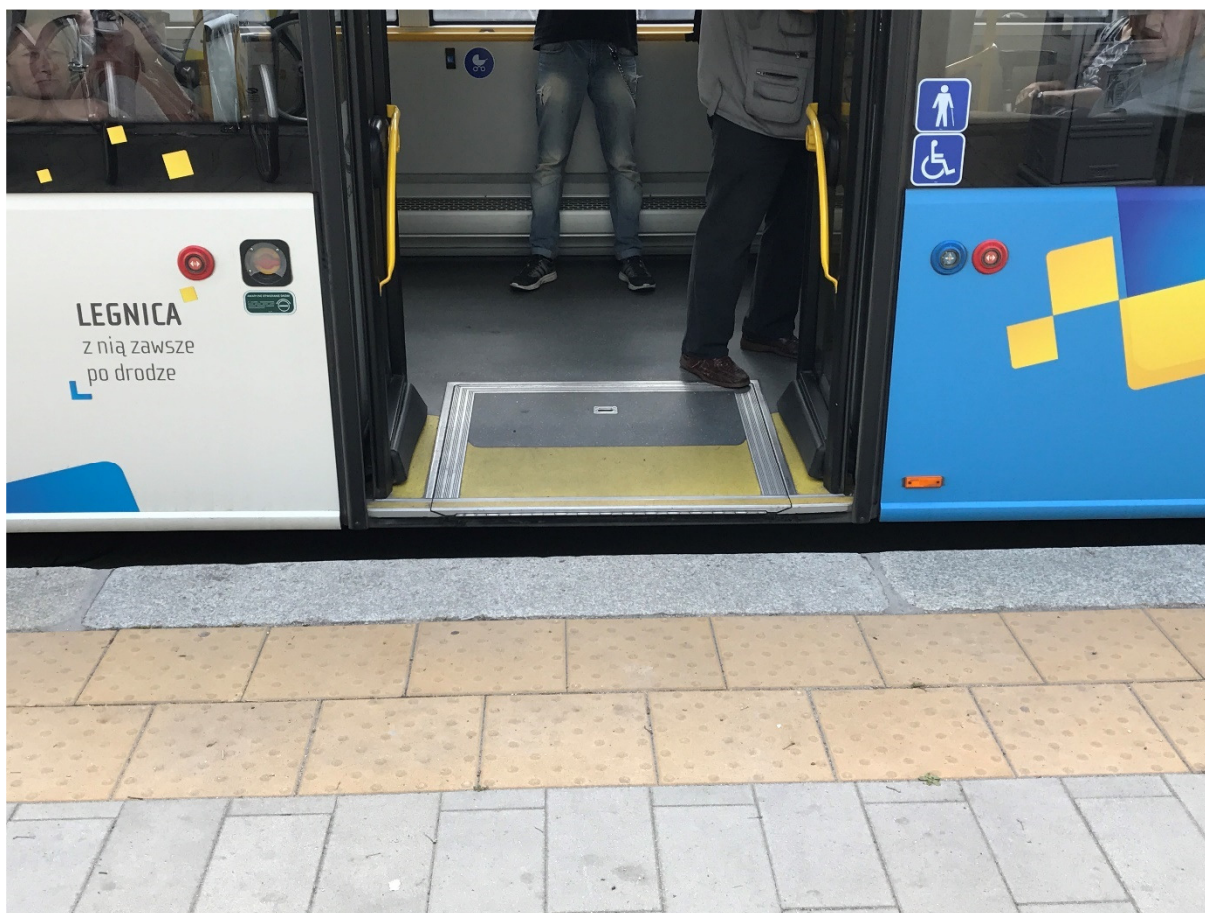
Rys. 9.4 Zminimalizowana przerwa między peronem przystankowym a autobusem Źródło: Zbiory własne
