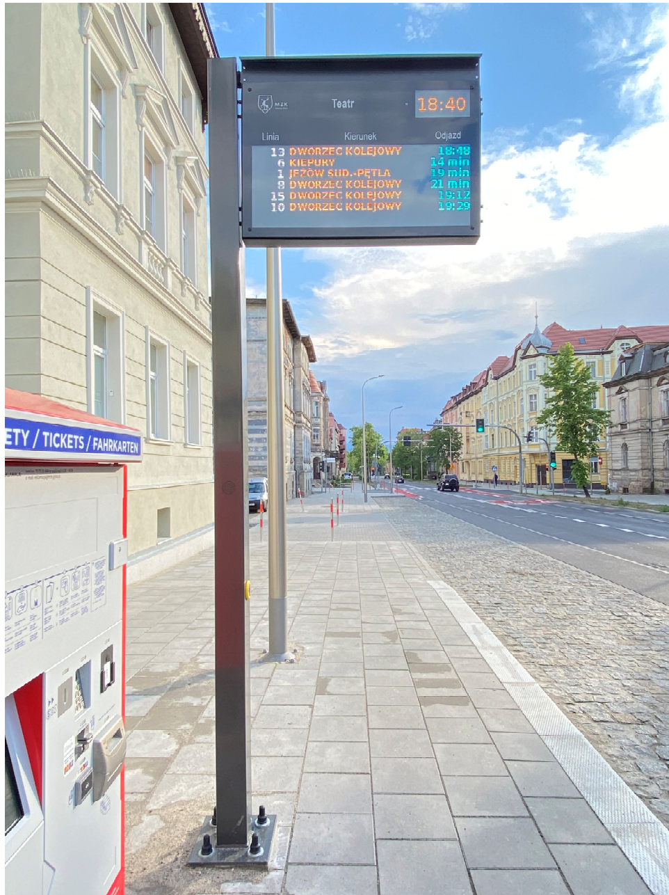
Rys. 11.2 Tablica przystankowa Dynamicznej Informacji Przystankowej w Jeleniej Górze
