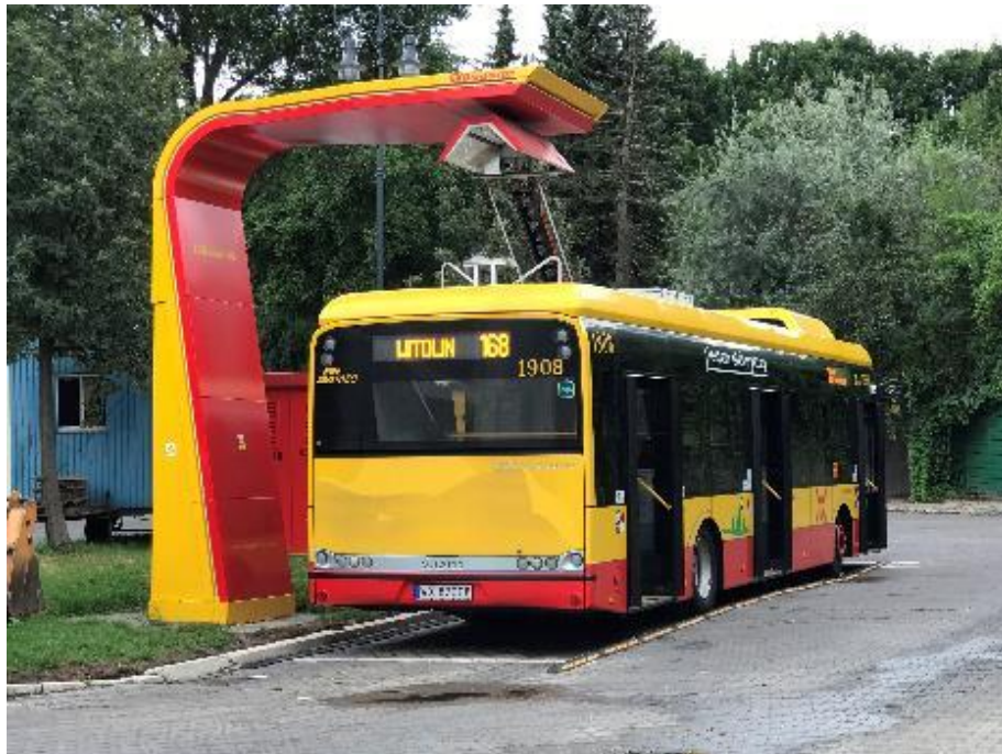
Rys. 4.3 Ładowanie autobusu elektrycznego akumulatorowego z ładowarki pantografowej w Warszawie
