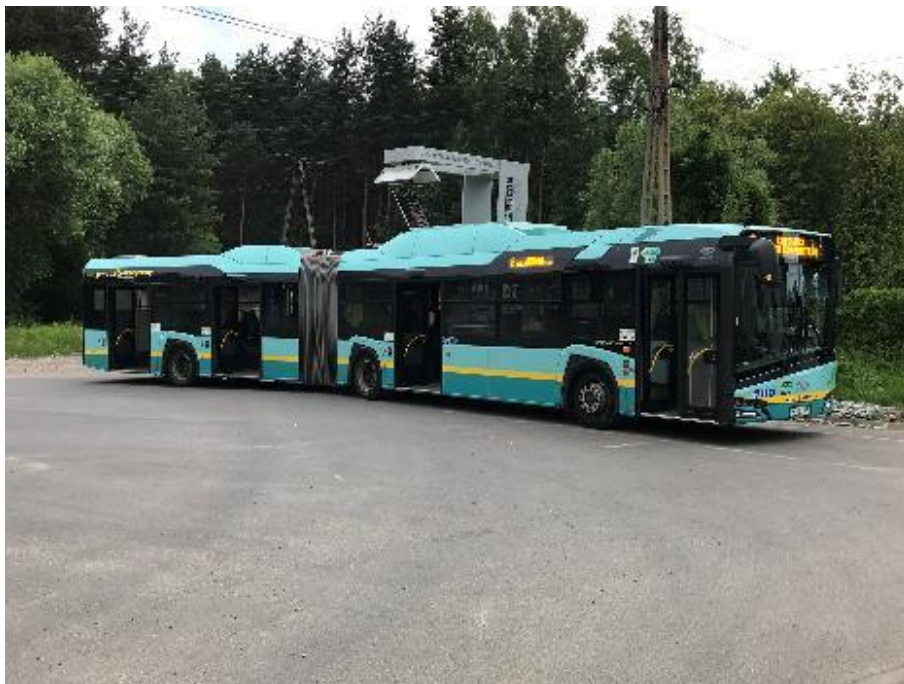
Rys. 4.1 Autobus elektryczny akumulatorowy typu MEGA18 w Jaworznie podczas szybkiego ładowania
