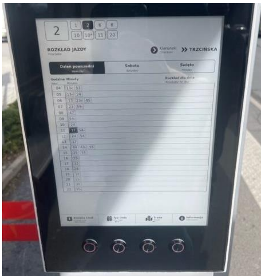
Rys. 11.3 Tablica dwuekranowa w technologii e-papieru w Jeleniej Górze
