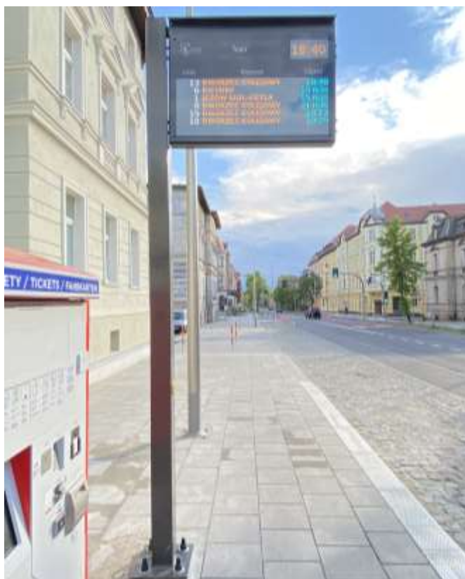
Rys. 11.2 Tablica przystankowa Dynamicznej Informacji Przystankowej w Jeleniej Górze
