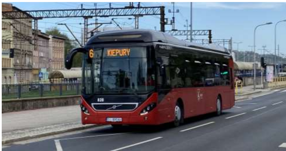
Rys. 9.2 W pełni niskopodłogowy hybrydowy autobus typu maxi Źródło: Zbiory własne
