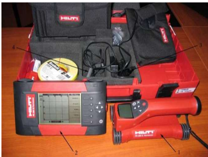
Rys. Z-1. Ferroskan Hilti PS 200: 1- głowica PS 200 S, 2- panel sterujący PS 200 M, 3- akumulator wraz z ładowarką, 4- kabel służący do przesyłania danych do komputera
