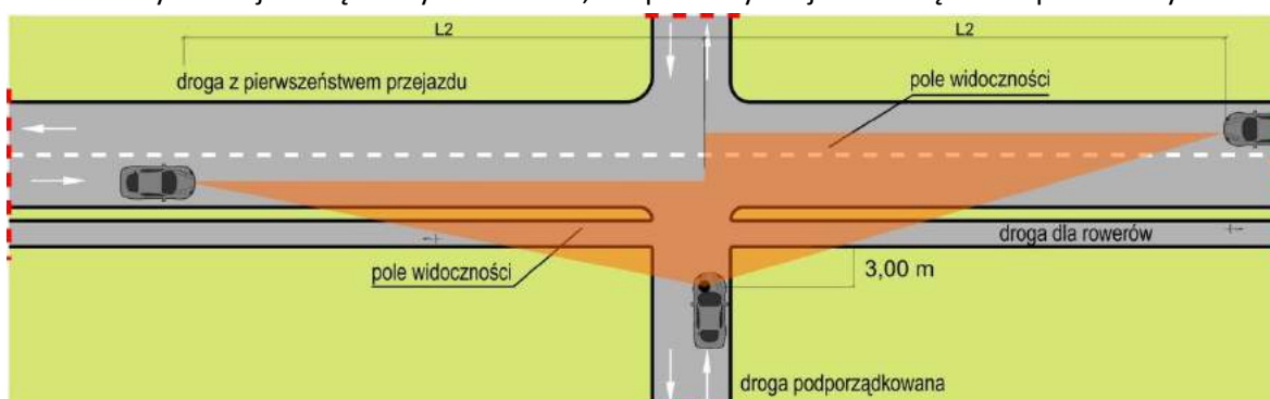
Schemat 29. Odległość widoczności przy ruszaniu pojazdu z miejsca.
