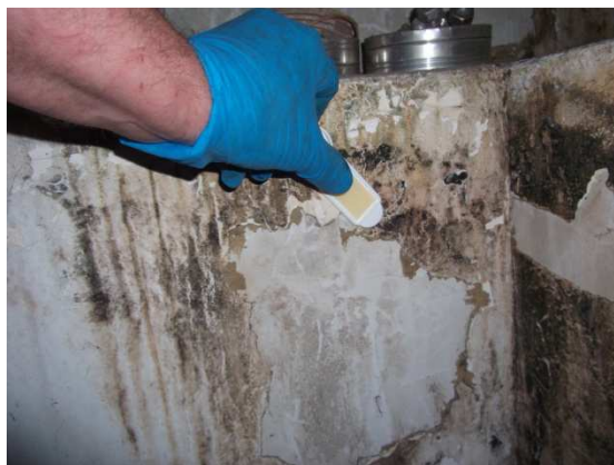
Fot. 30 Badania mikrobiologiczne przegród w węzle ciepłowniczym
