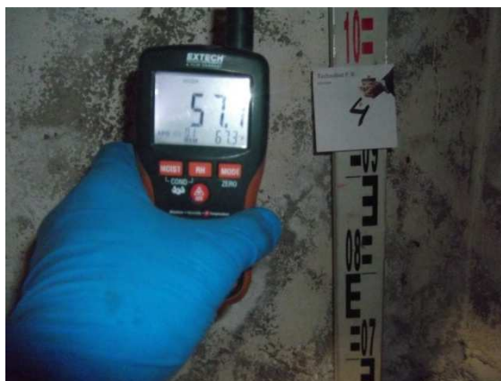
Fot. 19 Wilgotność względna b. wysoka 57,1% temp. pow. 19,7°C (67,5°F)
