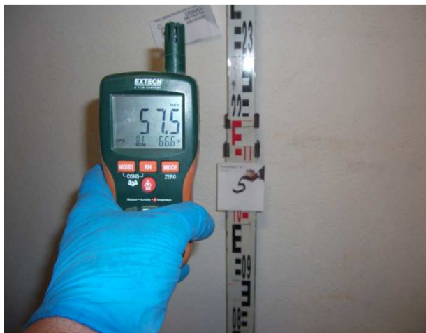
Fot. 21 Wilgotność względna powietrza 57,5% temp.19,2°C
