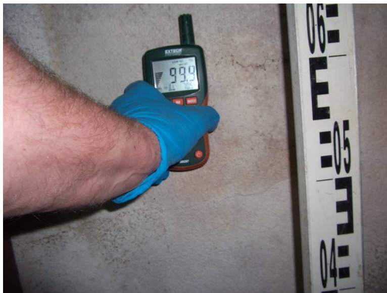
Fot. 6 Pomiar na ścianie bardzo wilgotnej
