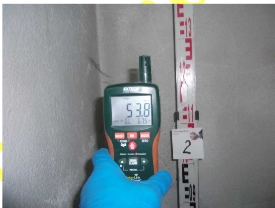
Fot. 11 Wilgotność względna powietrza – 53,8% temp. powietrza 19,7°C (67,5°F)
