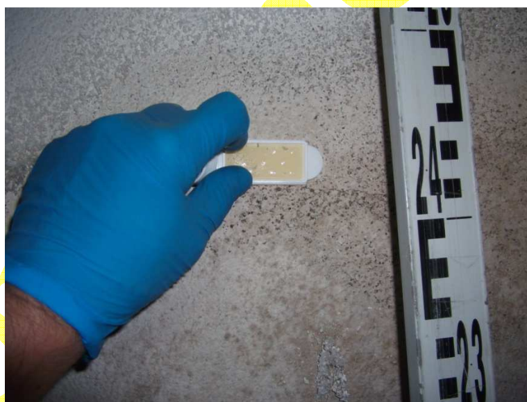
Fot. 9 Badania mikrobiologiczne powierzchni ściany paskiem odciskowym Tryptic Soyagar z TTC/ Agar z różem bengalskim w pomieszczeniu nr 1 (archiwum wydziału komunikacji)
