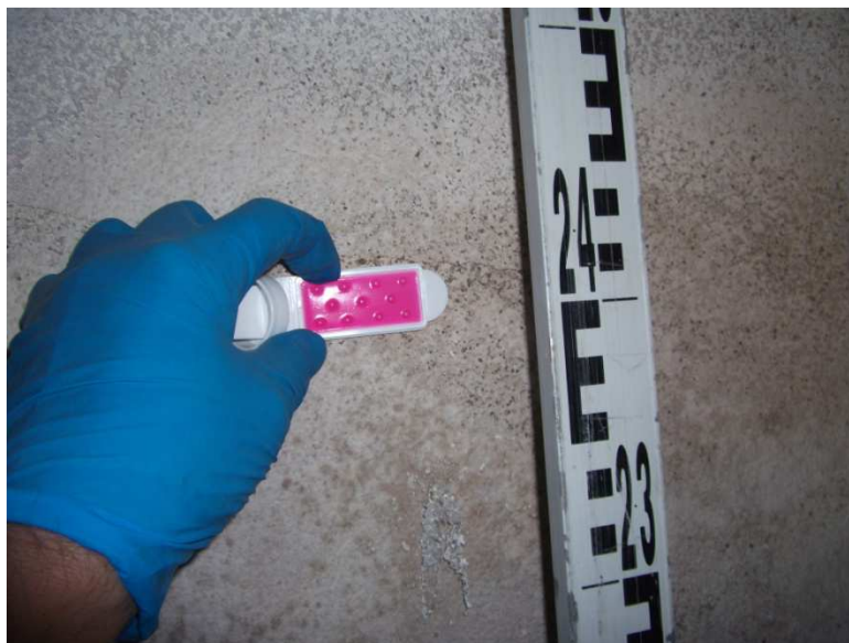
Fot. 8 Badania mikrobiologiczne powierzchni ściany paskiem odciskowym Tryptic Soyagar z TTC/ Agar z różem bengalskim w pomieszczeniu nr 1 (archiwum wydziału komunikacji)
