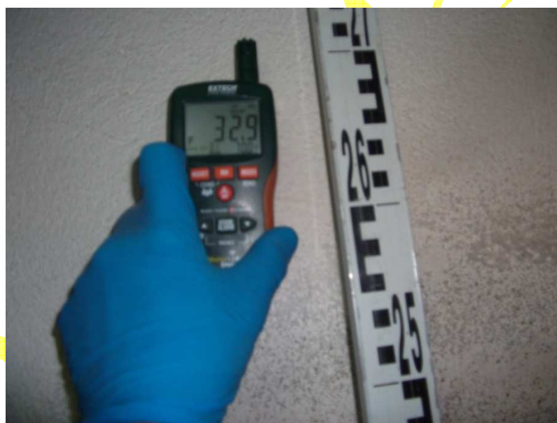
Fot. 7 Pomiar na ścianie o podwyższonej wilgotności
