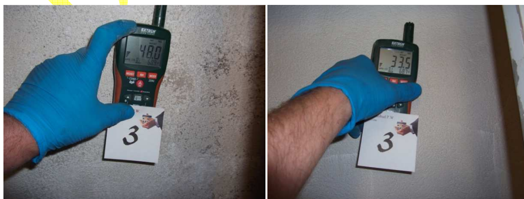
Fot. 15 Fot. 16 Wilgotność względna przegród wysoka 48%, 33% temp. powietrza 19°C
