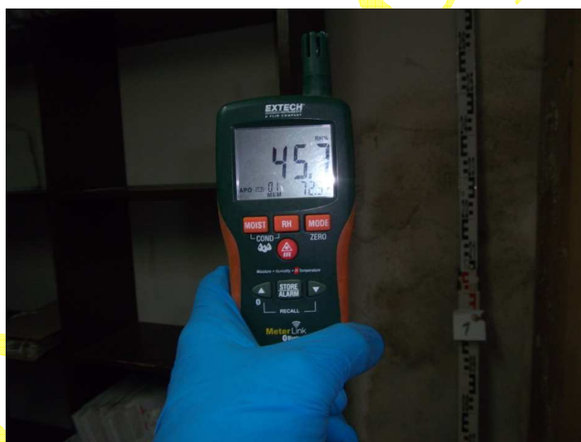
Fot. 5 Wilgotność względna w pomieszczeniu 45,7% temp. 22,5°C (72,5°F)
