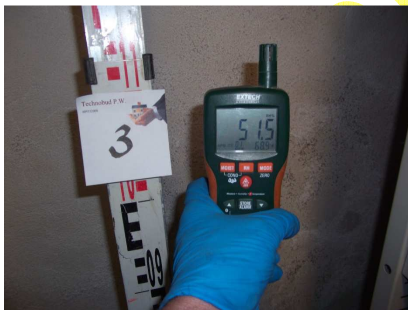
Fot. 14 Wilgotność powietrza pomieszczeniu nr 3. wynosi 51,5%
